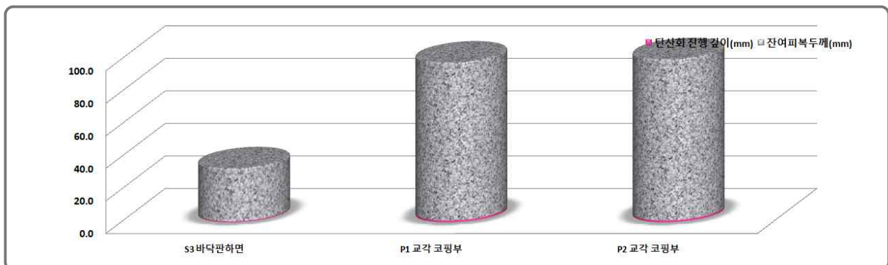
[그림 4.2.3] 탄산화깊이 및 잔여피복두께 측정결과
